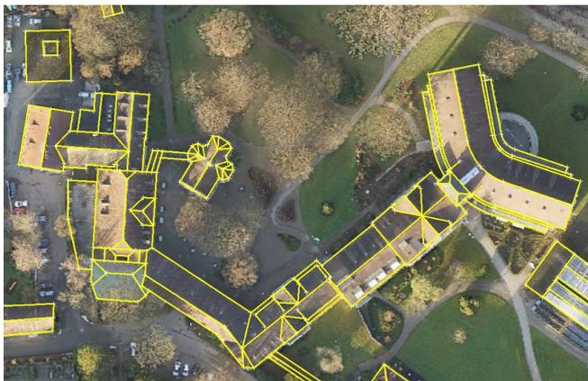
Orthophoto mit Dachkanten
