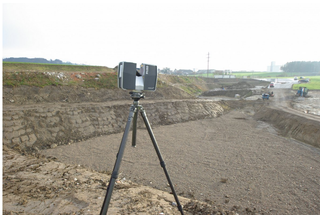
Aufnahme mit Laserscanner
