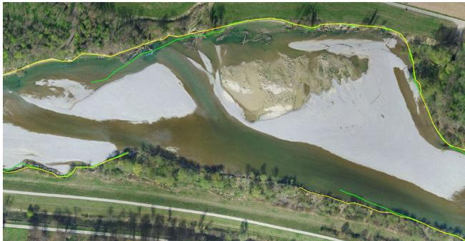
Orthophoto 2017 mit Abrisskanten von 2015 und 2017
