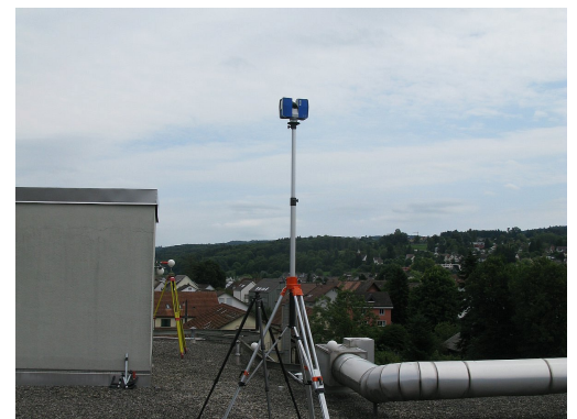
Scanning des Daches
