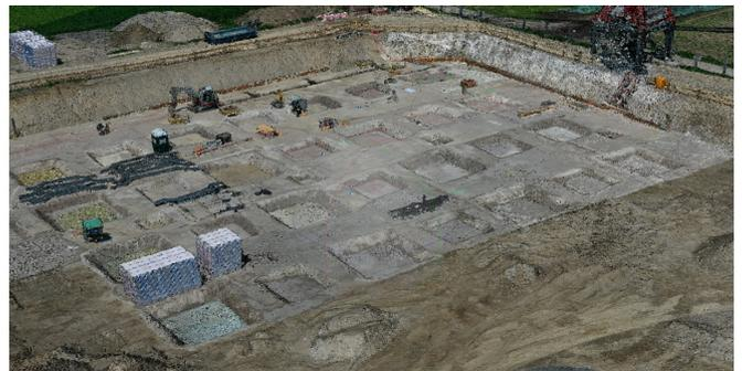
Punktwolke für Fertigungskontrolle OK Magerbeton
