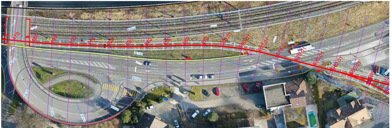
Aufbereitete 3D-Daten entlang des Gleisbereichs in Rheineck mit hinterlegtem, hochaufgelöstem Orthophoto der Drohnenaufnahme.
