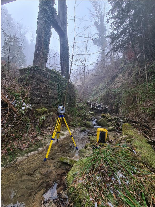
Tachymetrische Georeferenzierung der Laserscanning-Aufnahmen.
