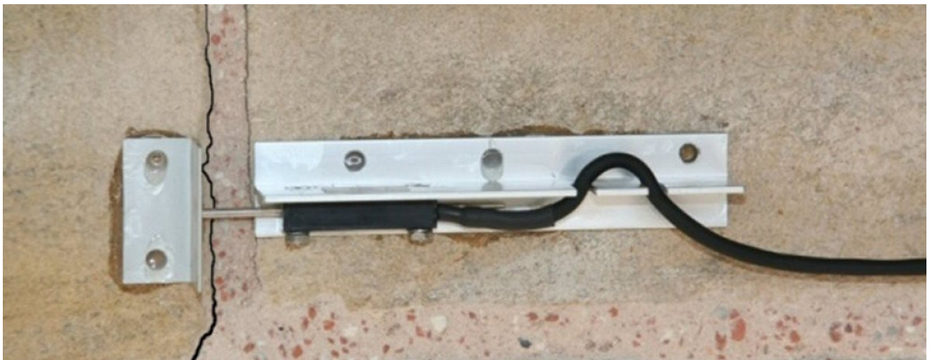
Sensor zur automatisierten Langzeitüberwachung von Rissbewegungen
